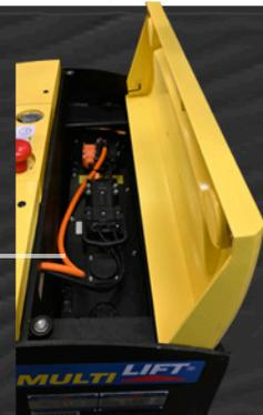
● Controlador **ZAPI** de corriente alterna. Suaviza los movimientos y optimiza la operación.
