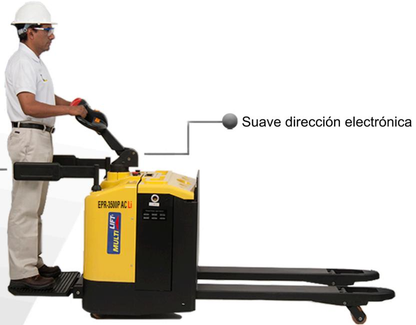
Protectores laterales antivuelco que garantizan la seguridad del operador.
