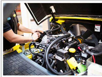
Sistema de enfriamiento mejorado que ayuda a la conservación de la transmisión y del motor. Gracias a su sistema de apertura, el asiento se eleva para tener acceso al motor por ambos lados.
