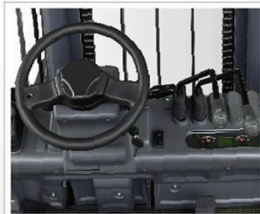
Volante con inclinación ajustable. Palancas ergonómicas para sistema de elevación, inclinación y desplazador lateral.
