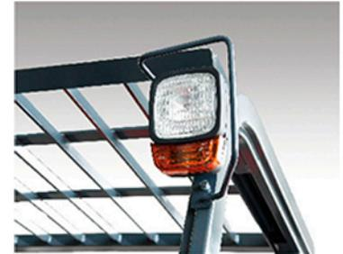
Luces delanteras y traseras. Incluye torreta estroboscópica.
