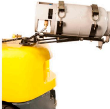
Sistema de tanque de gas abatible hasta 60°.
