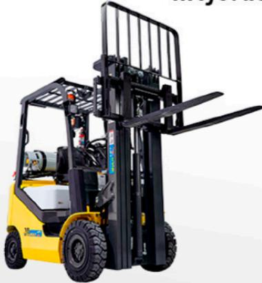
Exclusivo mástil Multilift fabricado con acero alemán de alta resistencia y amplia visibilidad.
