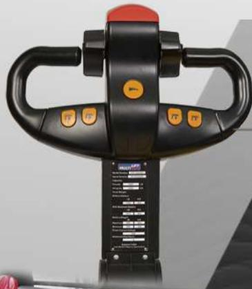
Dirección electrónica asistida y barra de controles de velocidad, ascenso y descenso.
