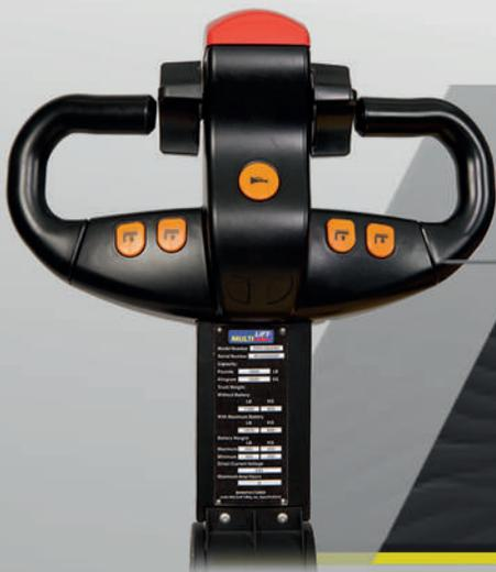
**Dirección electrónica asistida y barras de controles** con control de velocidad, ascenso y descenso.
