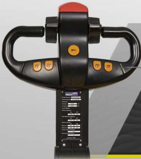
● **Dirección electrónica asistida y barra de control con ajustes de velocidad, ascenso y descenso de horquillas.**
