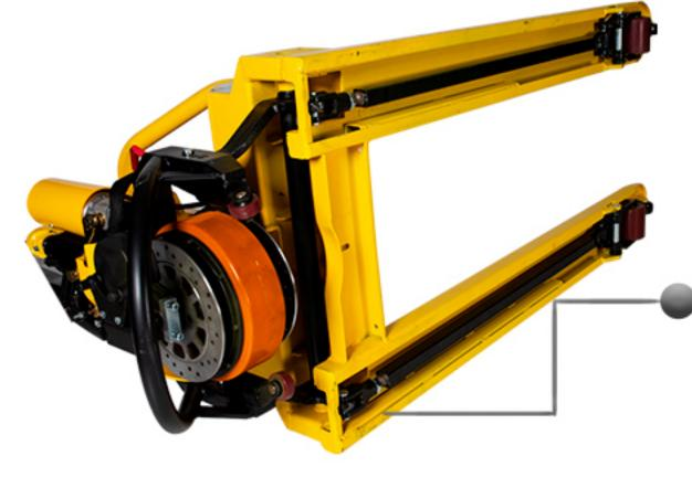
Sus llantas caster estabilizan el equipo aún en giros muy pronunciados o con cargas inestables. Construcción robusta de alta calidad Refuerzos a lo largo de las horquillas.
