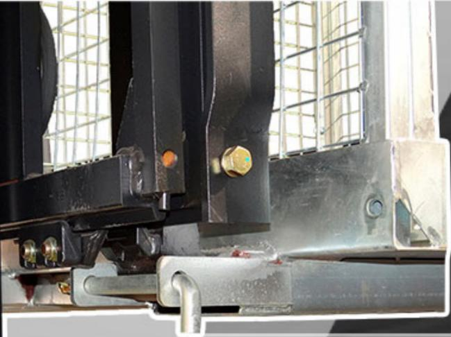
**Pernos de seguridad** que bloquean las horquillas para evitar que se deslicen brindando seguridad y firmeza.
